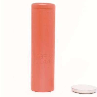
Die Kodierung 18650 resultiert aus den Abmessungen der Zelle. Hierbei stehen die ersten beiden Ziffern für einen Durchmesser von 18mm, die folgenden 650 für eine Länge von 65mm. Hierbei sind die 650 durch 10 zu teilen. Bei einer herkömmlichen Lithium-**Knopfzelle [7]** CR2032 hat die Zelle einen Durchmesser von 20mm und eine Dicke von 3,2mm. Andere Zellen wie Mignon, Mikro und Mono lassen sich auch in dieses Schema eingruppiieren.
