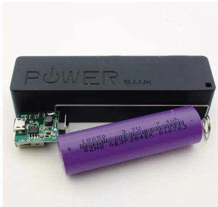
Die kleine Platine in jeder Powerbank erfüllt mehrere Funktionen. Sie enthält einen Aufwärtswandler, der die Gleichspannung des Akkus auf eine konstante Gleichspannung von 5V anhebt, einen Überlastschutz, der abschaltet, wenn der Ausgangsstrom von 0,5A überschritten wird, einen Tiefentladeschutz und eine Ladeelektronik. Nachteil der Schaltungen sind die Wandlungsverluste beim Wandeln auf 5V beziehungsweise beim Laden der Zelle.
