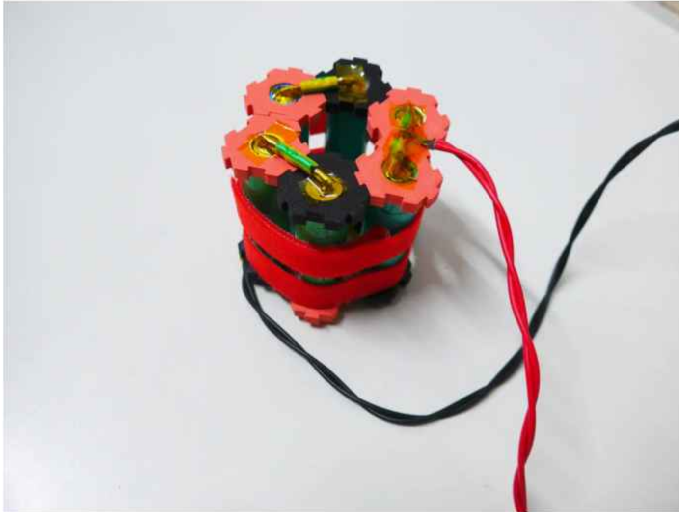
3S2P-Akku mit selbstgedruckter Halterung
