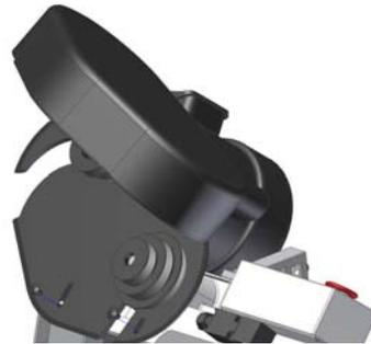
Abb. 3-7: Montage-Keilriemengehäuse
