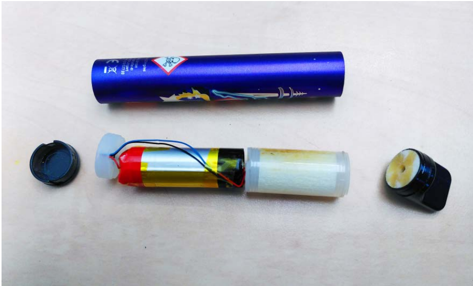
Bild 1: Der Akku ist neben der Gehäusehülle das größte und vermutlich teuerste Bauteil einer E-Zigarette.
